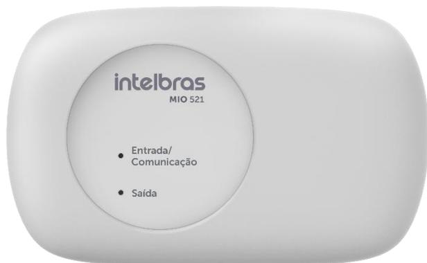
O módulo MIO 521 possui além da entrada de contato seco, uma saída de relé configurável para NA ou NF, permitindo acionar dispositivos como portas corta-fogo, sistemas de combate, controles de acesso entre outros.
